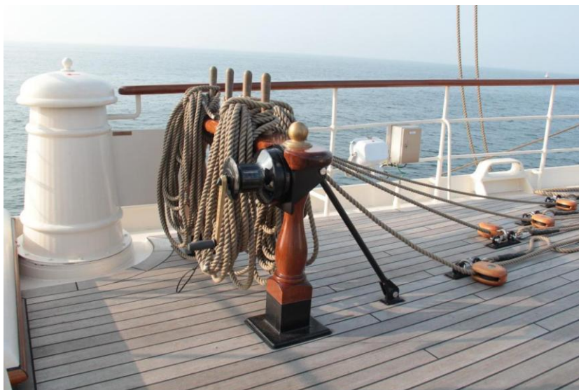
Rysunek 10 Przykłady typowego nagielbanku do szotów, fałów i niderholerów sztaksli i kliwrów z kabestanem ręcznym.
