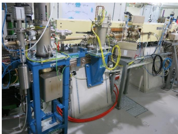
Rysunek 1. Zdjęcia pierścienia akumulacyjnego w obszarze pierwszej części front endu magnesu zakrzywiającego, a), dla dedykowanej sekcji pierścienia akumulacyjnego, w której zostanie zainstalowany front end, b) dla już istniejącej i zainstalowanej pierwszej części front endu.
