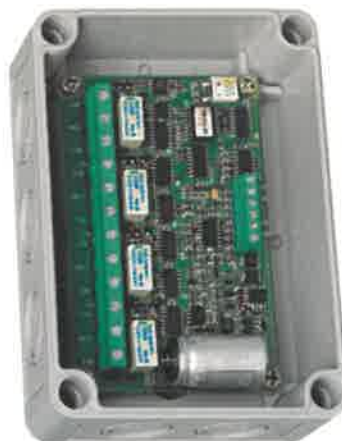
Rys. 9 Widok modułu BX-REL4
