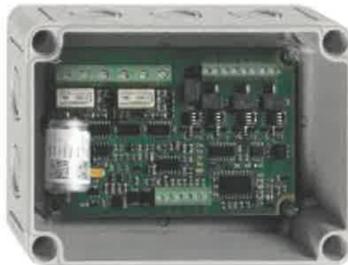
Rys. 7 Widok modułu BX-OI4
