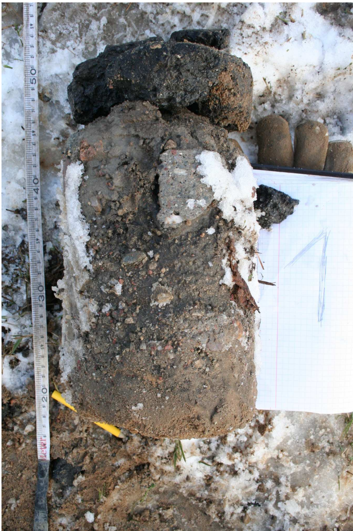
Budowa podłoża ulicy A.Wrzoska w Poznaniu Profil przewiertu przez jezdnię w pkt. I Data: styczeń 2017 r.
