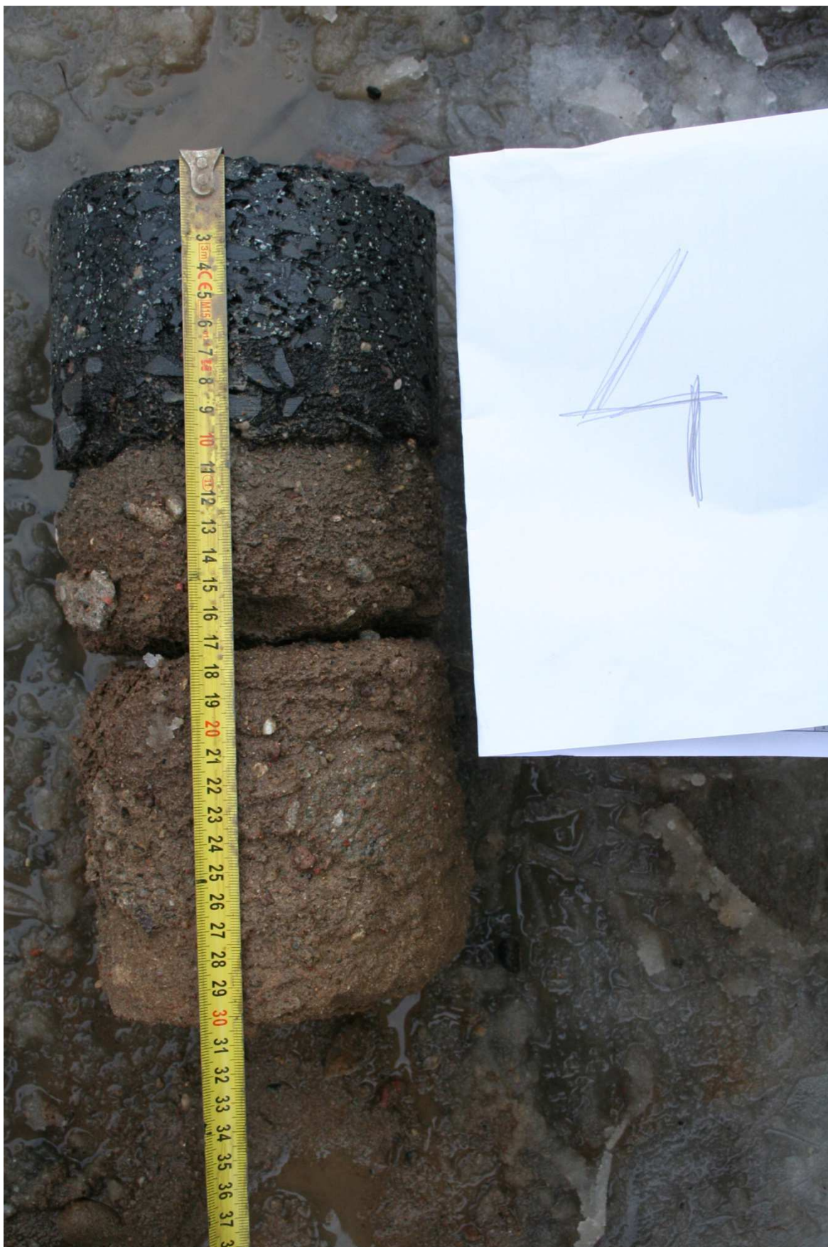
Budowa podłoża ulicy A.Wrzoska w Poznaniu Profil przewiertu przez jezdnię w pkt. IV Data: styczeń 2017 r.
