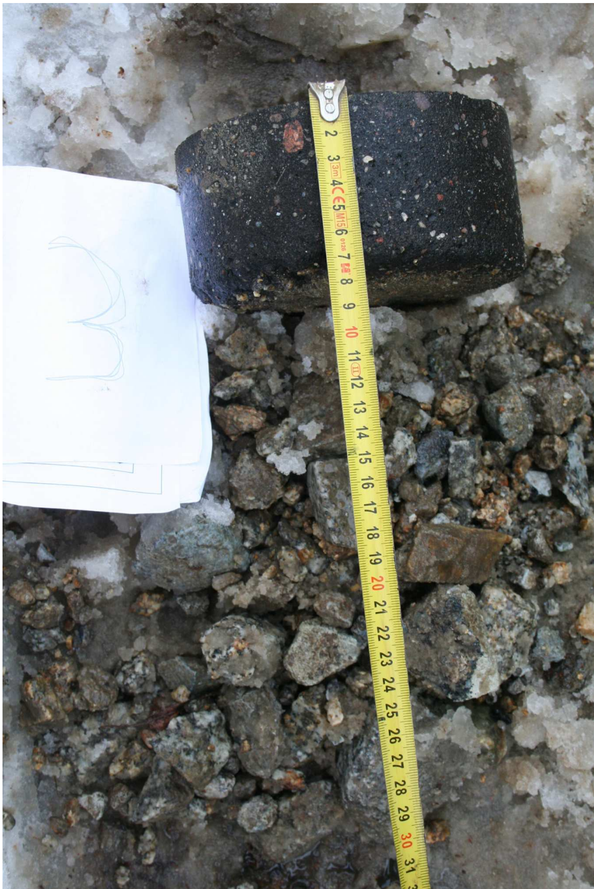
Budowa podłoża ulicy A.Wrzoska w Poznaniu Profil przewiertu przez jezdnię w pkt. III Data: styczeń 2017 r.
