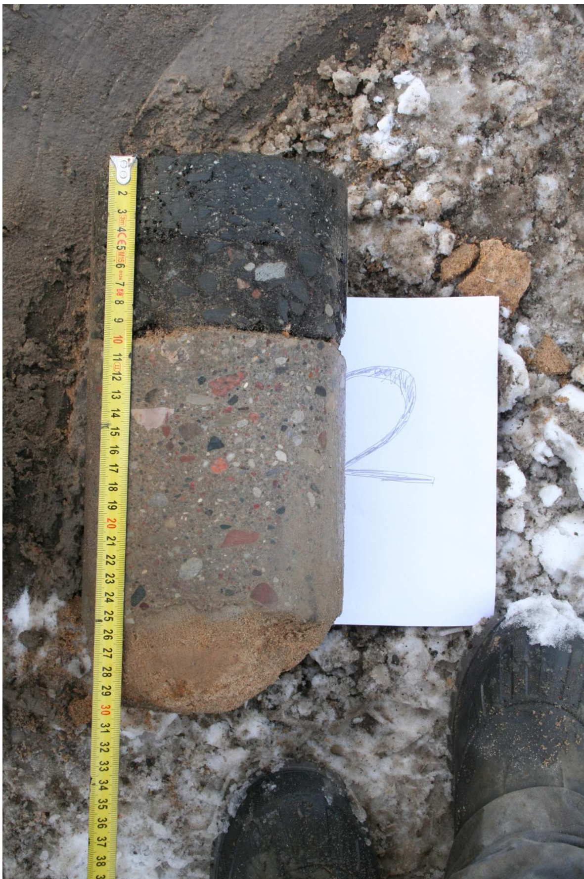
Budowa podłoża ulicy A.Wrzoska w Poznaniu Profil przewiertu przez jezdnię w pkt. II Data: styczeń 2017 r.
