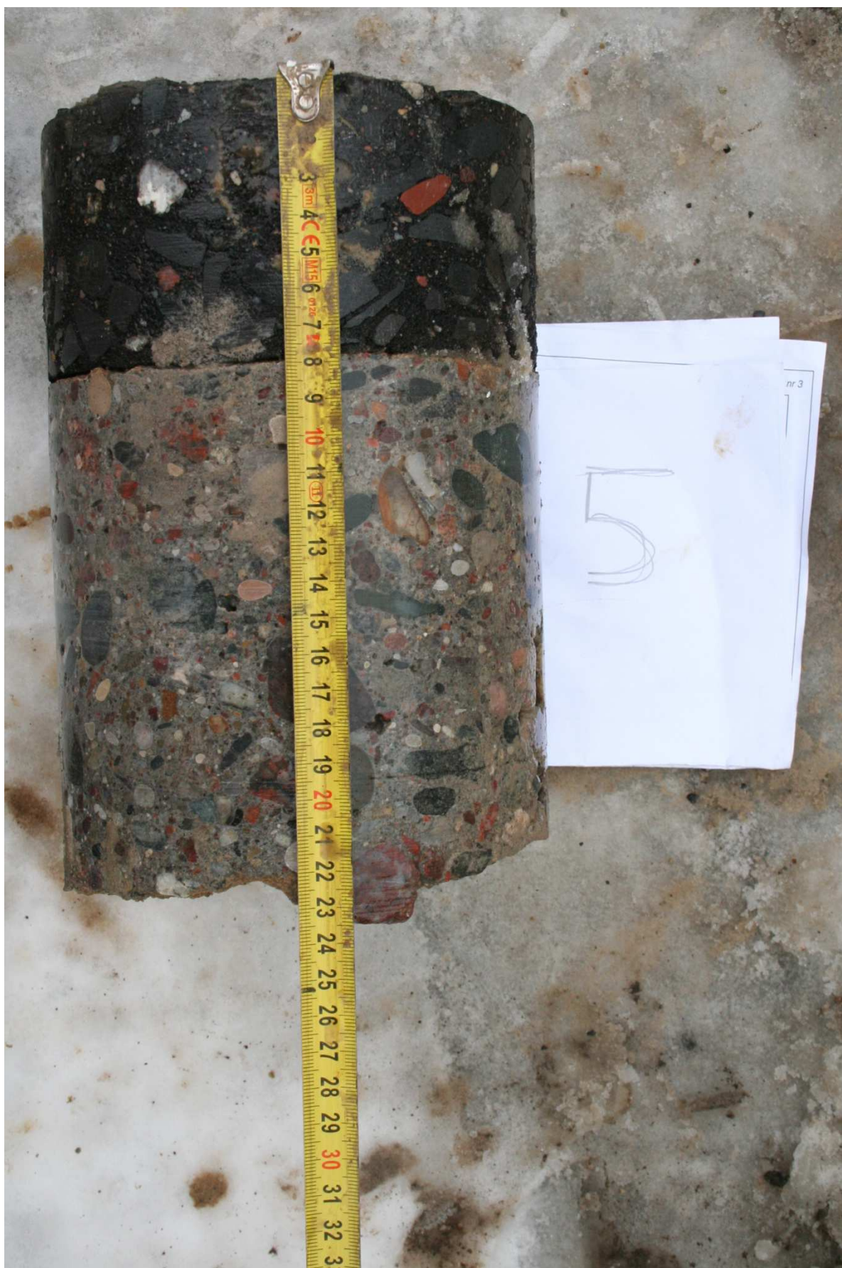
Budowa podłoża ulicy A.Wrzoska w Poznaniu Profil przewiertu przez jezdnię w pkt. V Data: styczeń 2017 r.
