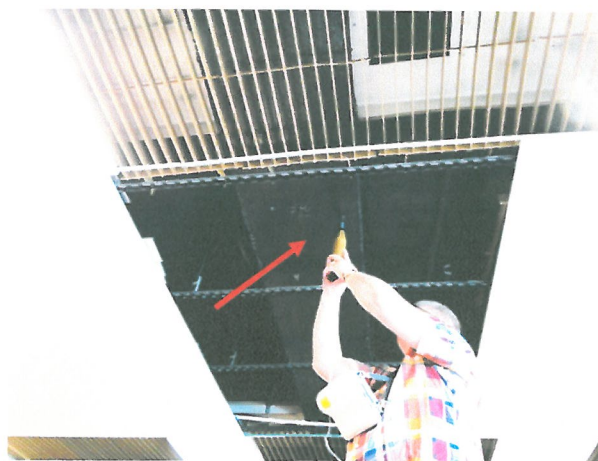
Fot. 20. Miejsce 5, pomiar wytrzymałości betonu.
