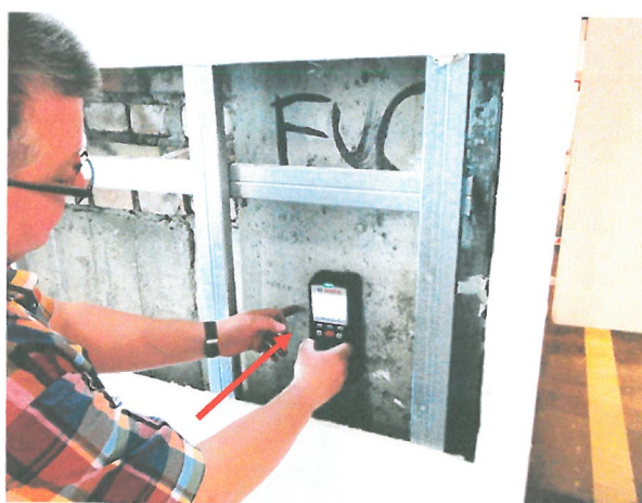
Fot. 11. Badanie zbrojenia w miejscu 3 na słupie.
