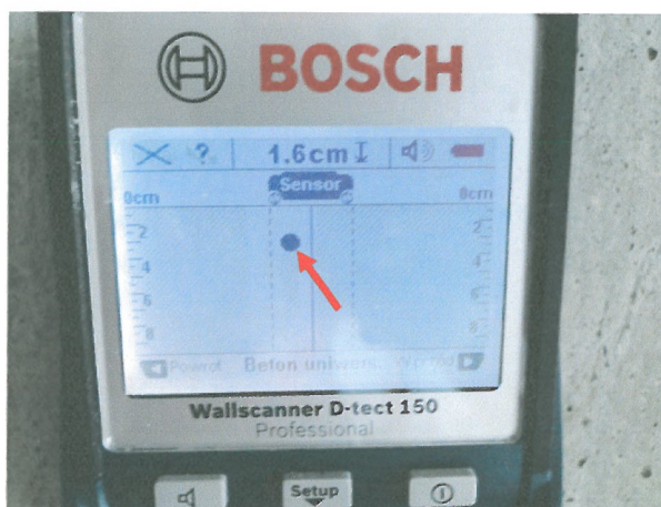
Fot. 4. Pręt zbrojeniowy z otuliną 1,6 cm
