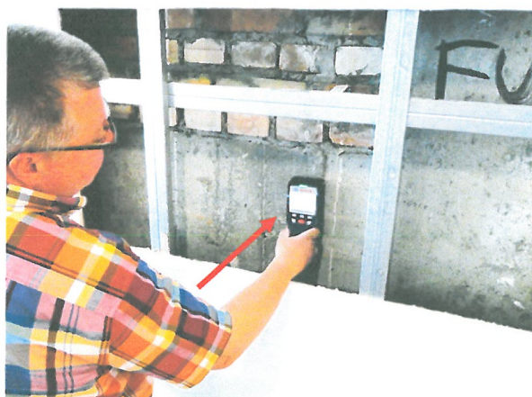
Fot. 14. Badanie zbrojenia ściany w miejscu 3.
