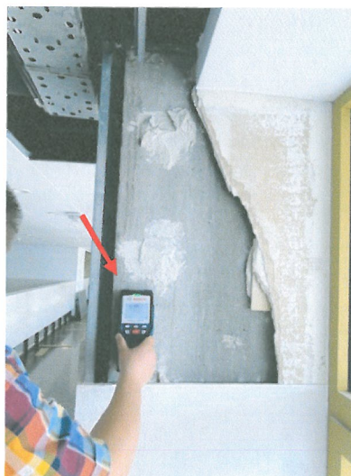
Fot. 3. Badanie zbrojenia słupa w miejscu 1
