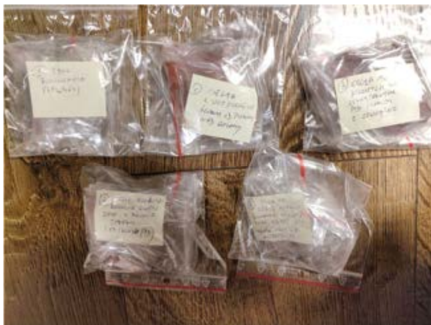
Fot. 19. Pobrane próbki zabezpieczone przed zmianami wilgotności, przygotowane do wysyłki
