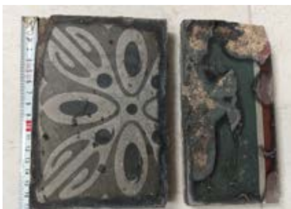
Fot. 20 Widoczne zniszczenia lica płytek kamionkowych i przekrój płytki.
