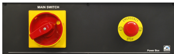
Rysunek 1.1: Ulokowanie wyłączników bezpieczeństwa - szafa elektryczna
