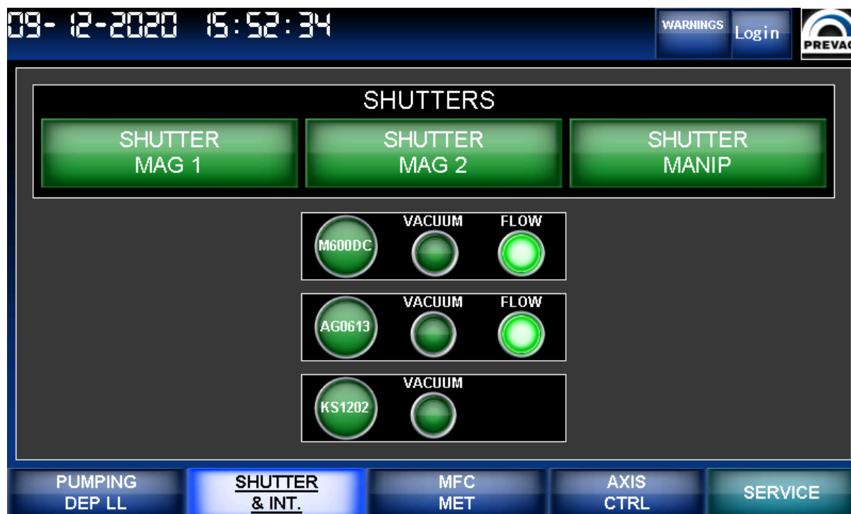
Rysunek 5.4: Panel HMI z wyświetlonymi shutterami oraz interlockami
