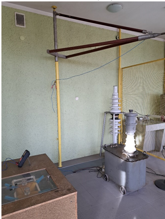
6. Stanowisko do badania wytrzymałości doraźnej dielektryków stałych (celka 6)
