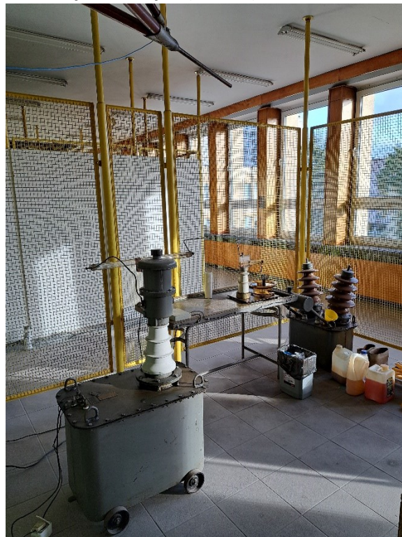
6. Stanowisko do badania wytrzymałości doraźnej dielektryków stałych (celka 6)
