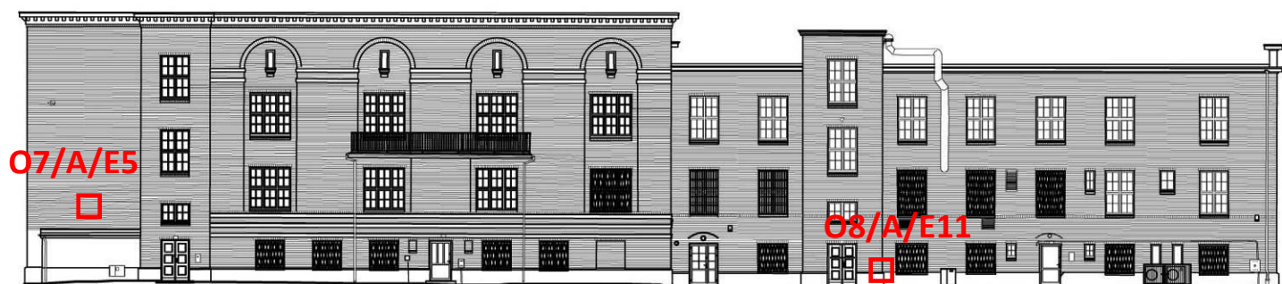
Rys. 6. Schemat wykonanych odkrywek na elewacji południowej budynku A.
