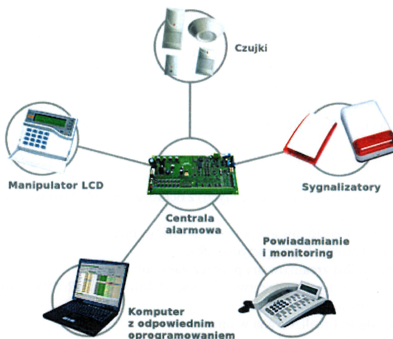
Rysunek 13.1. Przykładowa struktura systemu SSWiN
