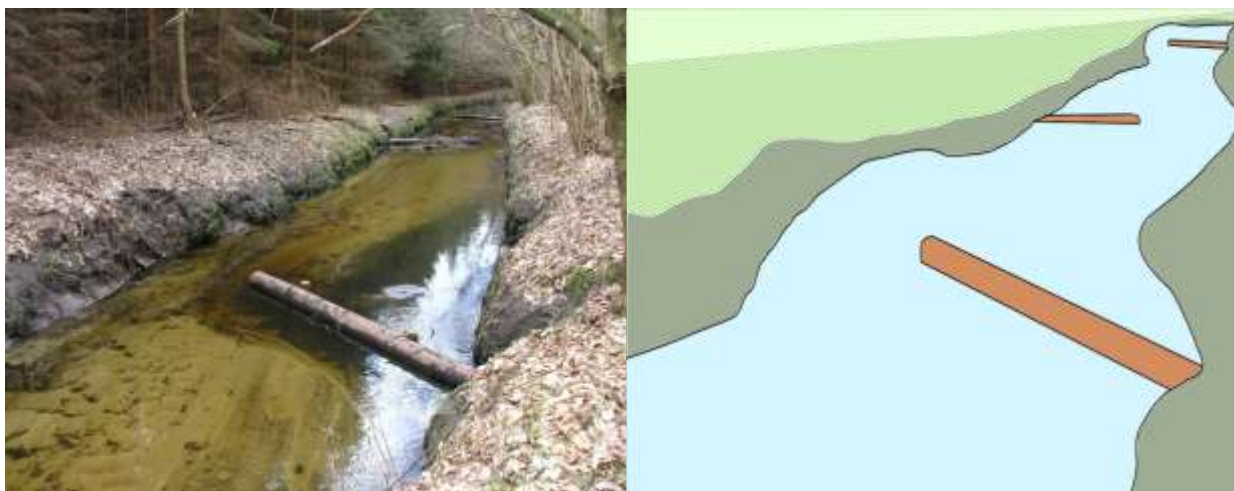
Najprostsze deflektory drewniane na wyprostowanym cieku wywołują pożądane zmiany w dnie i na przeciwnym brzegu
