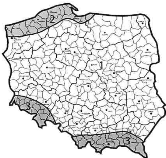
Rys. 1.2 Podział Polski na strefy obciążenia wiatrem [24]
