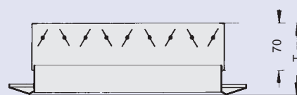
...-AG Przepustnica regulacyjna z przeciwbieżnymi kierownicami ustawianymi od przodu.
