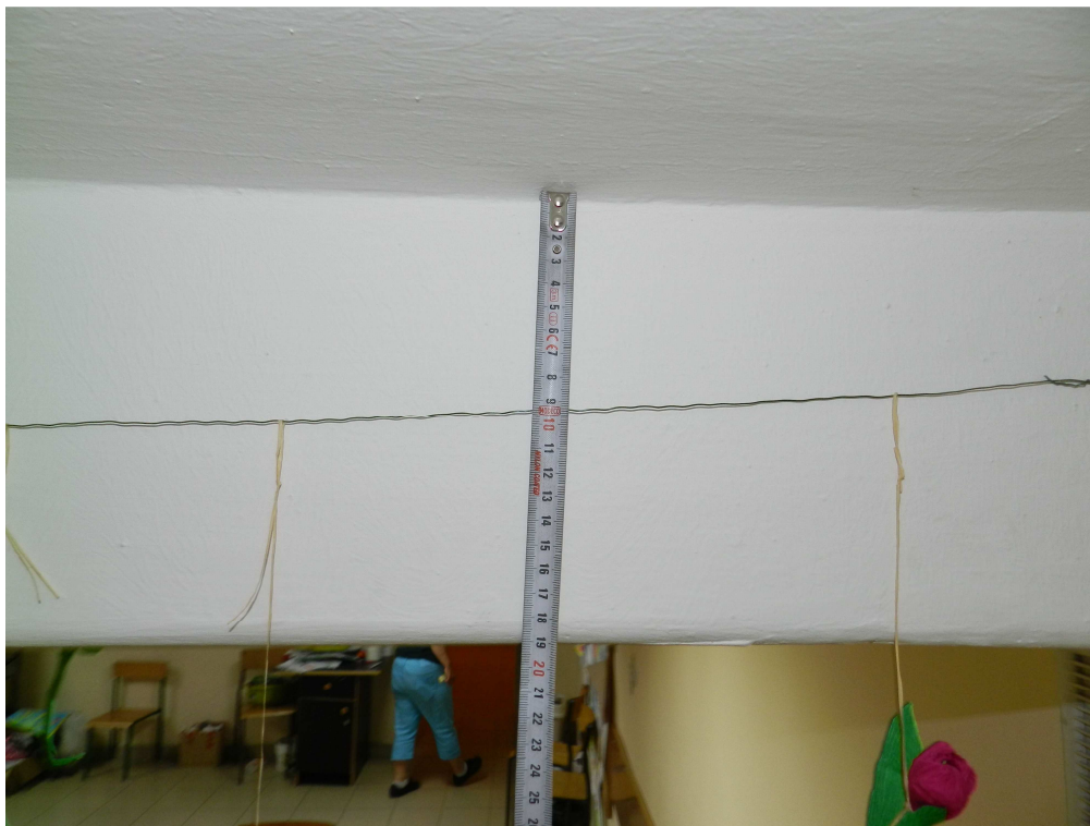
fot.3. Pomiar wysokości belek żelbetowych w kondygnacji piwnic.
