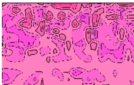
Rysunek 31 Rozkład przestrzenny wraz z dystrybucją wskaźnika zrozumiałości mowy (STI) dla funkcji teatralnej ze sceną centralną
