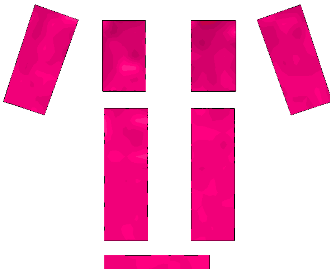
Rysunek 50 Rozkład przestrzenny wraz z dystrybucją wskaźnika zrozumiałości mowy (STI) dla funkcji koncertu akustycznego
