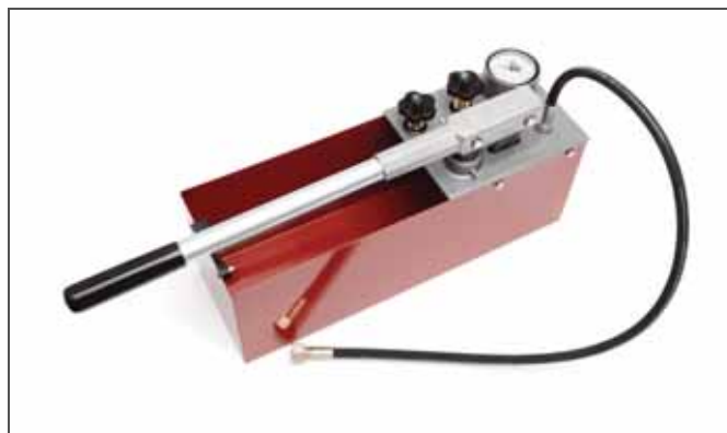
Rys. 5-6 Pompa tłokowa
