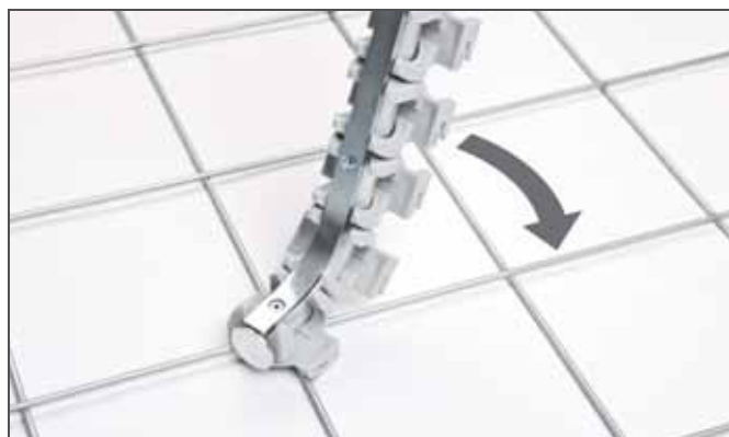
Rys. 3-49 Ustawić przyrząd montażowy z założonym magazynkiem klipsów
