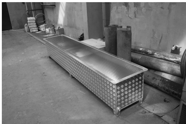
Rys.3 Widok elementów chłodni wodno - powietrznej
