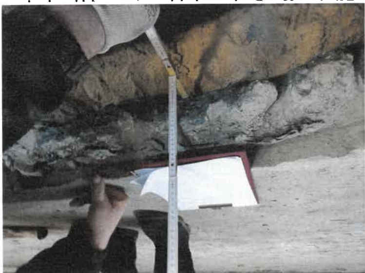
Zdjęcie nr 22. Pomiar grubości warstw posadzki w piwnicy.
